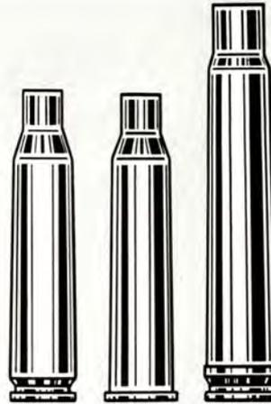
Hülsen mit unterschiedlicher Bodenverlaufsform: Von links randlose Hülse, Randhülse, Gürtelhülse.
